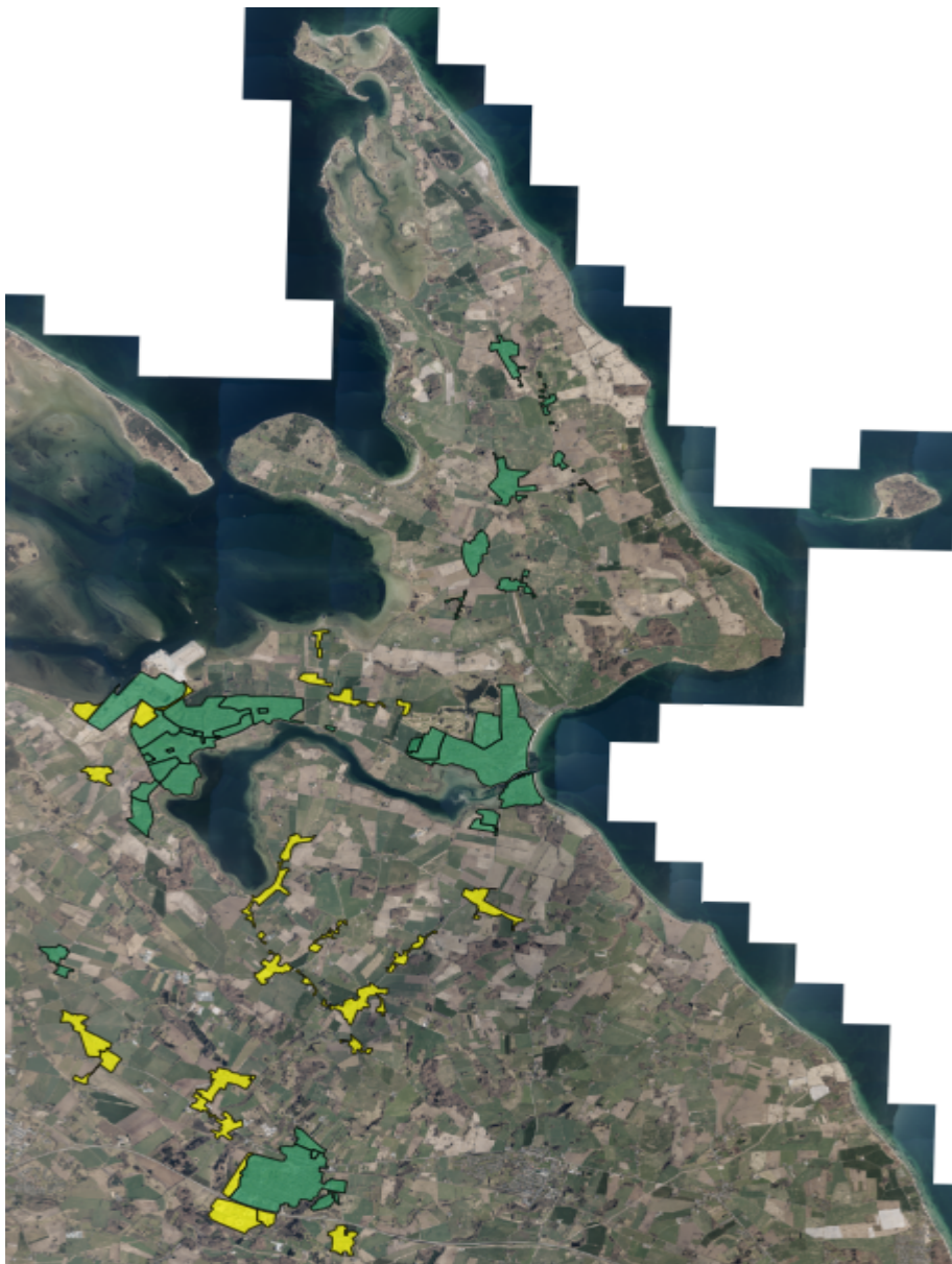
Figur 1: Godkendte forsyningsområder i Kerteminde Kommune (november 2022). Grøn farve viser godkendte områder til fjernvarme og gul farve viser godkendte områder til individuel naturgasforsyning.
